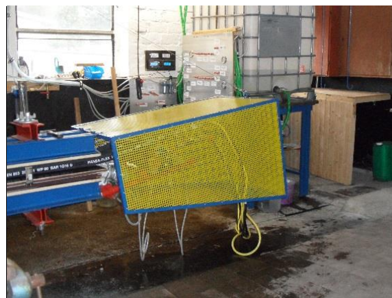
Hydraulikschlauch während der Prüfung
