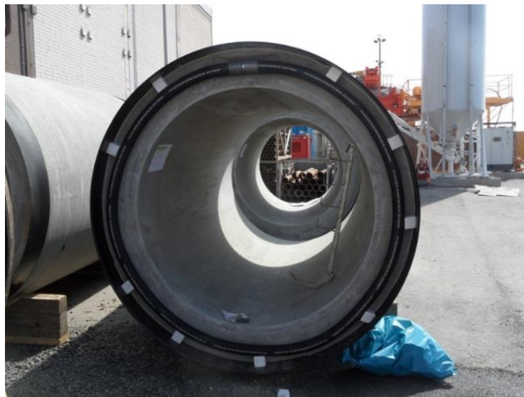
TuSo Einzelschlauch System eingesetzt seit 2014
