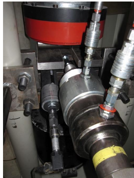
Einleitung der horizontalen Kraft über Zylinder
