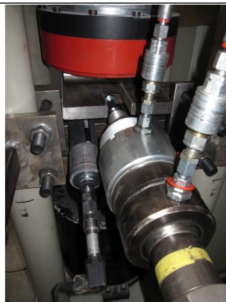
Einleitung der horizontalen Kraft über Zylinder
